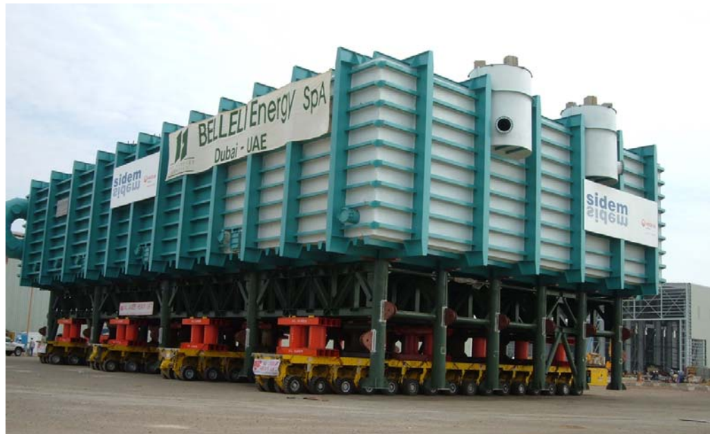
Load out a 1700 te MED Unit in the U.A.E
